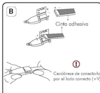
Abra la tapa del conector e inserte la cinta LED, cierre la tapa y presione hasta asegurar.
