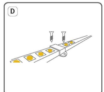
Use las abrazaderas para fijar a la superficie de instalación.
