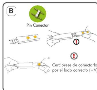
Inserte el Pin conector en el extremo de la cinta que va a conectar a la energía.
