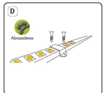
Use las abrazaderas para fijar a la superficie de instalación.
