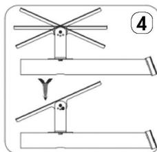
4. Ubique el soporte del panel solar en el ángulo de mayor incidencia solar y fije los tornillos en la perforación que coincida. Ajuste todos los tornillos.
