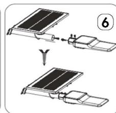
6. Instale la luminaria solar: Introduzca el cable de conexión de la luminaria a través del brazo metálico pasando el cable por el orificio inferior, luego ensamble la luminaria al brazo y ajuste los tornillos de la misma. Conecte el cable de la luminaria al cable del panel solar y asegure con la rosca del conector hermético.
