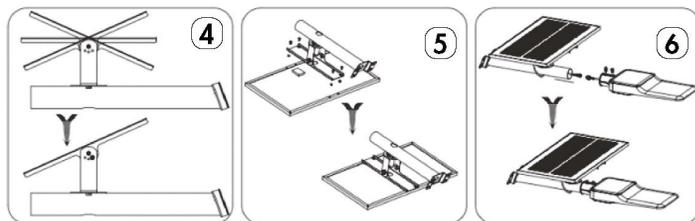
4. Ubique el soporte del panel solar en el ángulo de mayor incidencia solar y fije los tornillos en la perforación que coincida. Ajuste todos los tornillos.
