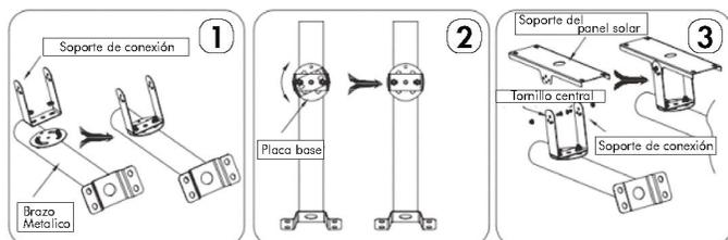
1. Instale el soporte de conexión al brazo metálico utilizando los tornillos y tuercas (incluidas), sin ajustar.
