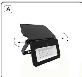
Desatornille y separe el soporte del reflector solar
