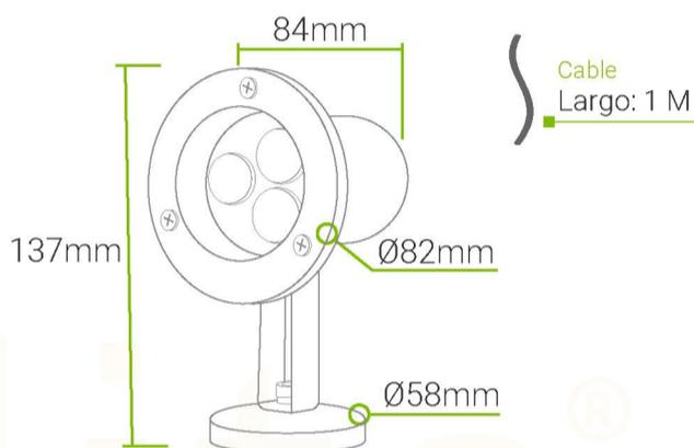
Las luminarias de una sola temperatura de color trabajan con fuentes de poder DC12V
